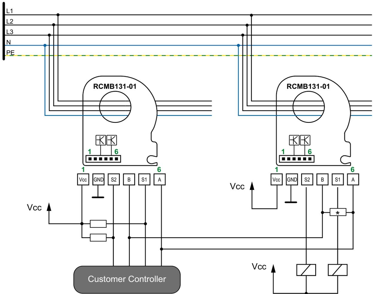
\* La résistance de terminaison 120 Ω ne doit être réglée que sur le dernier appareil de la chaîne du bus RS-485
